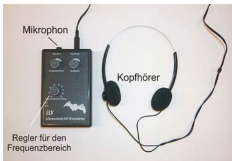
Abb. 5 Der Fledermausdetektor. Über ein Mikrophon werden Ultraschallsignale aufgefangen und im Detektor in Frequenzen umgewandelt, die im menschlichen Hörbereich liegen. Mit dem Kopfhörer kann man die konvertierten Signale dann hören. Über einen Regler kann der Frequenzbereich eingestellt werden, in dem die Ultraschallsignale empfangen werden.
